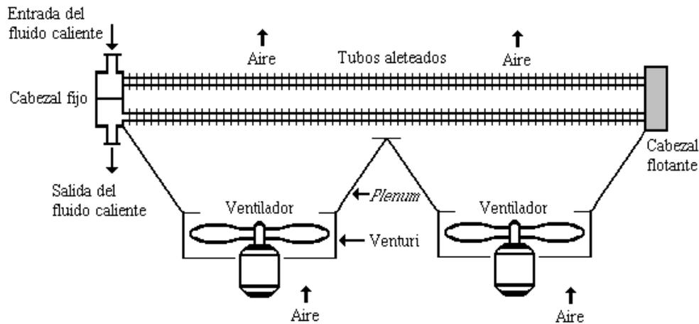
Figura I.3- 8: Intercambiador en flujo cruzado con corriente forzada.
