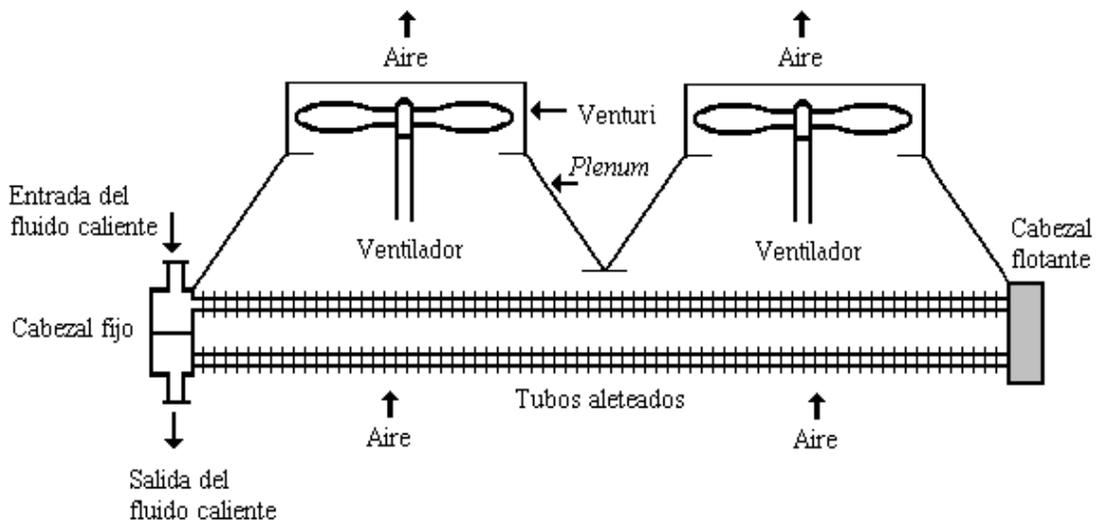
Figura I.3- 9: Intercambiador en flujo cruzado con corriente inducida.
