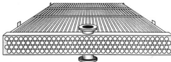
Figura I.3- 3: Haz de tubos típico de un ACHE
