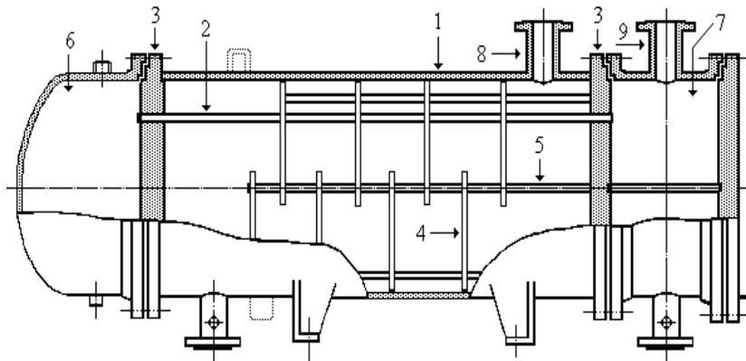
Figura I.1- 2: Intercambiador de tubo y carcaza.
