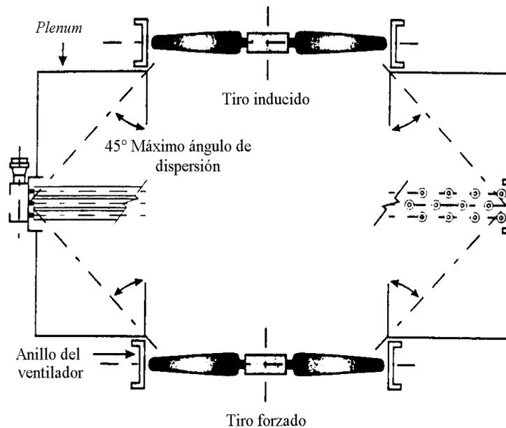
Figura I.3- 10: Dispersión del aire en los ventiladores
